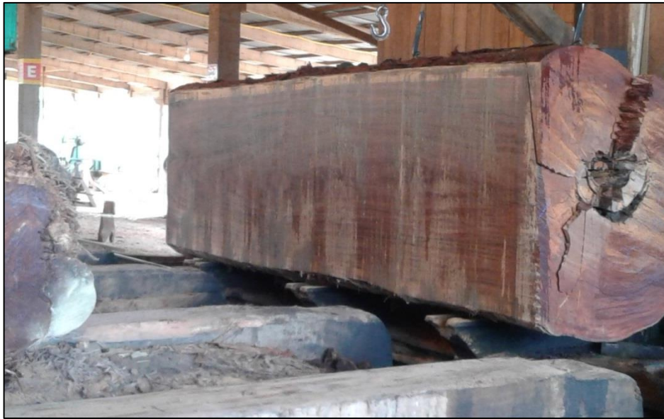
Figura 15 - Tora de Massarandura com oco e rachadura
