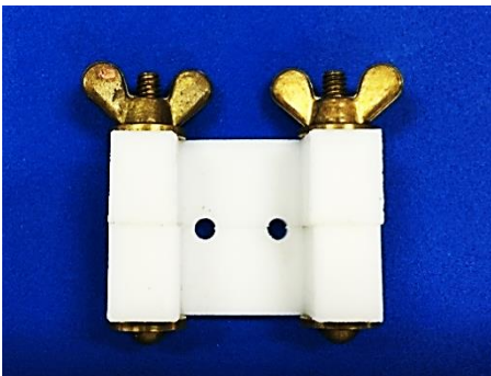
Figura 11. Moldes de teflon de 3,58 mm de altura e 3 mm de diâmetro.
