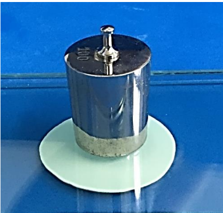
Figura 9. Peso colocado centralmente sobre o material.
