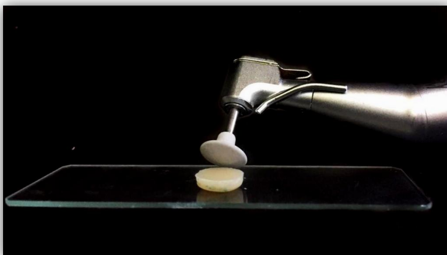
Figura 7. Polimento com taça de borrachas e disco de feltro
