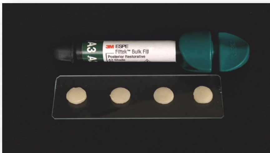
Figura 6. Espécime em forma de disco representando G1, G2, G3, e G4 da resina Filtek Bulk Fill.
