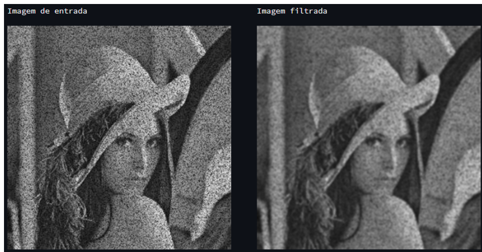
Figura 22 – Filtro de Gaussiano aplicando Kernel 5x5
