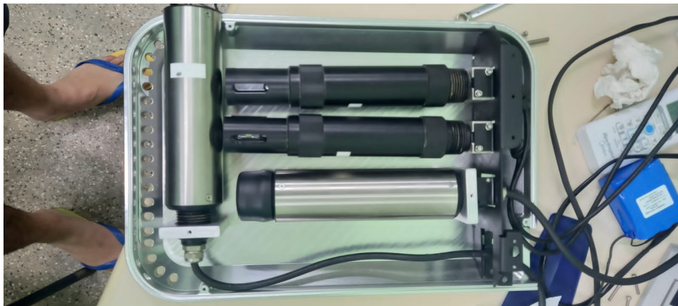
Figura 33 – Disposição das sondas de medição de parâmetros de qualidade de água.
