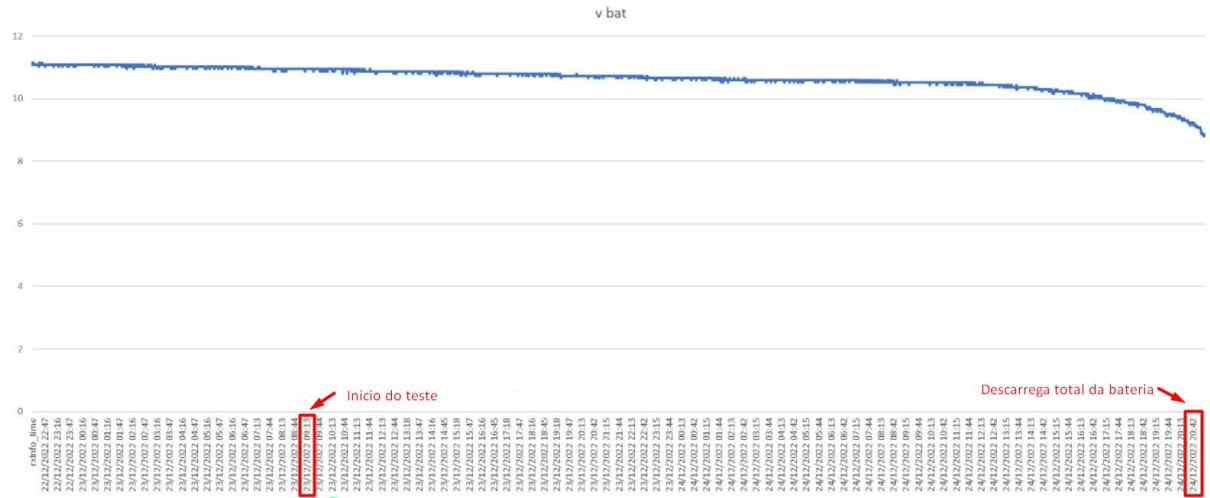
Figura 31 – Curva de descarga da bateria.
