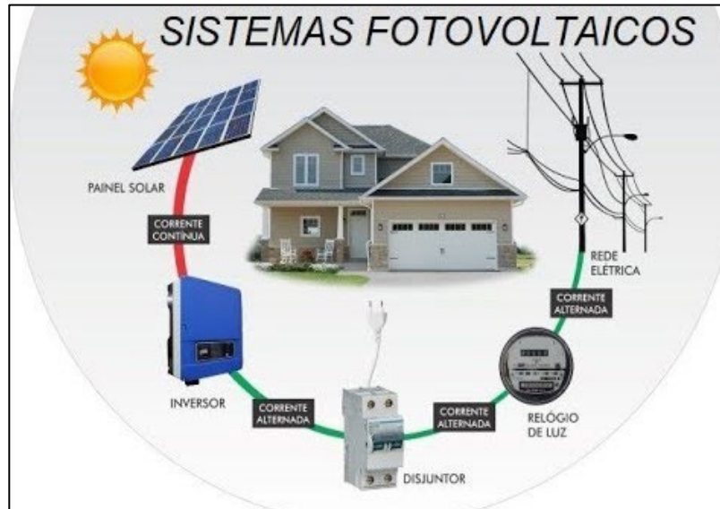
Figura 12 - Diagrama de um sistema fotovoltaico conectado à rede
