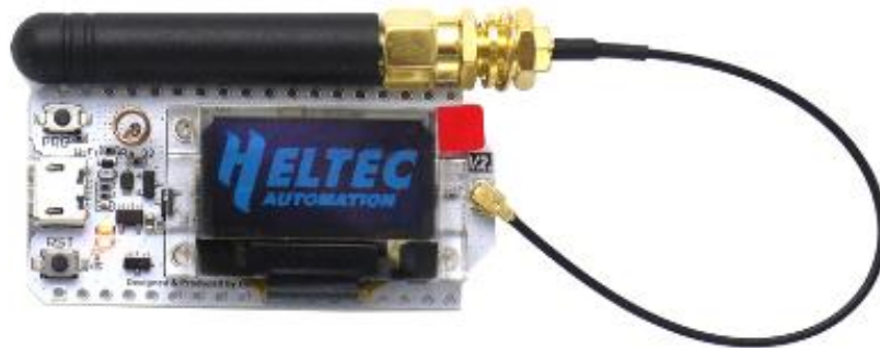
Figura 17 – Módulo ESP32 Heltec Wifi LoRa (V2).
