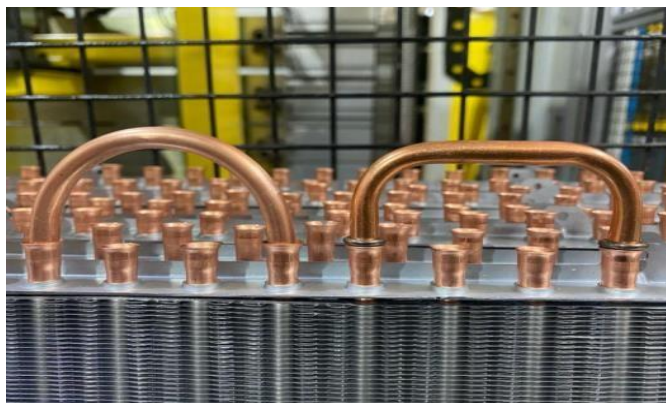
Figura 25 - Curva maior feita em matriz de dobra 3D ao lado da Curva maior antiga com duas dobras.
