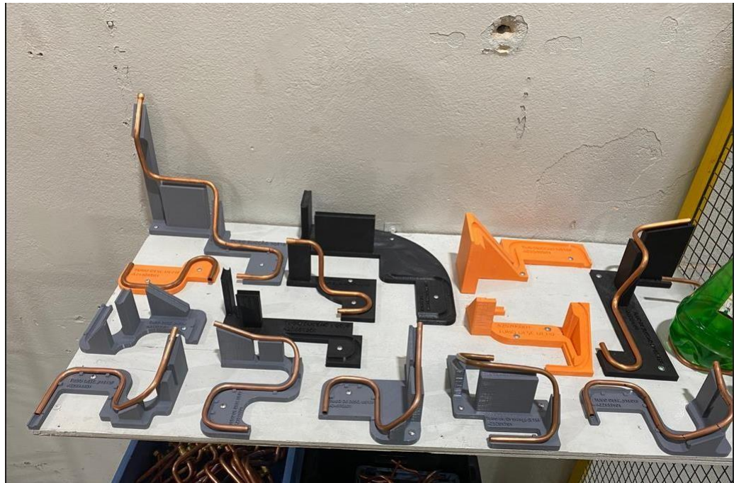
Figura 34 – Gabaritos de verificação dimensional de tubos de cobre feitos na impressora 3D
