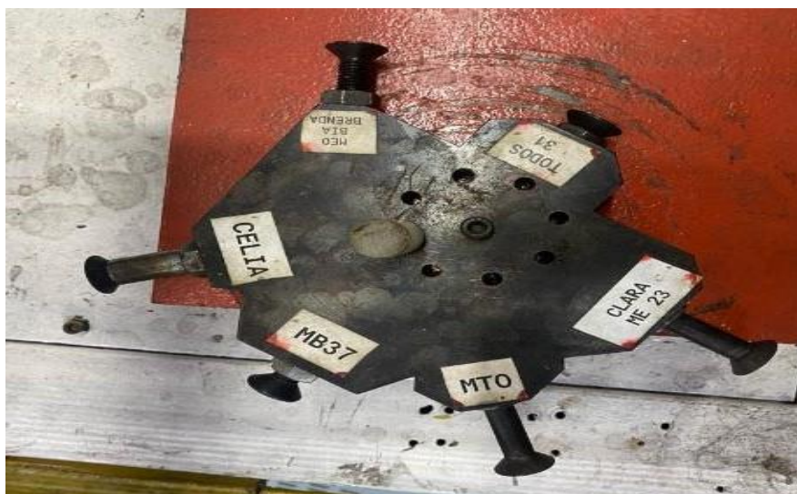
Figura 29 – Matriz de Setup feita em impressão 3D em máquina de dobra de gabinete com todos os modelos identificados
