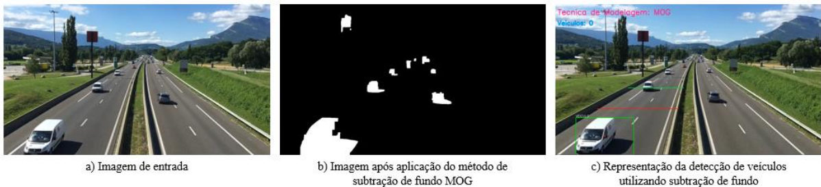
Figura 48 - Frames do vídeo de entrada e imagem após processamento por subtração de fundo
