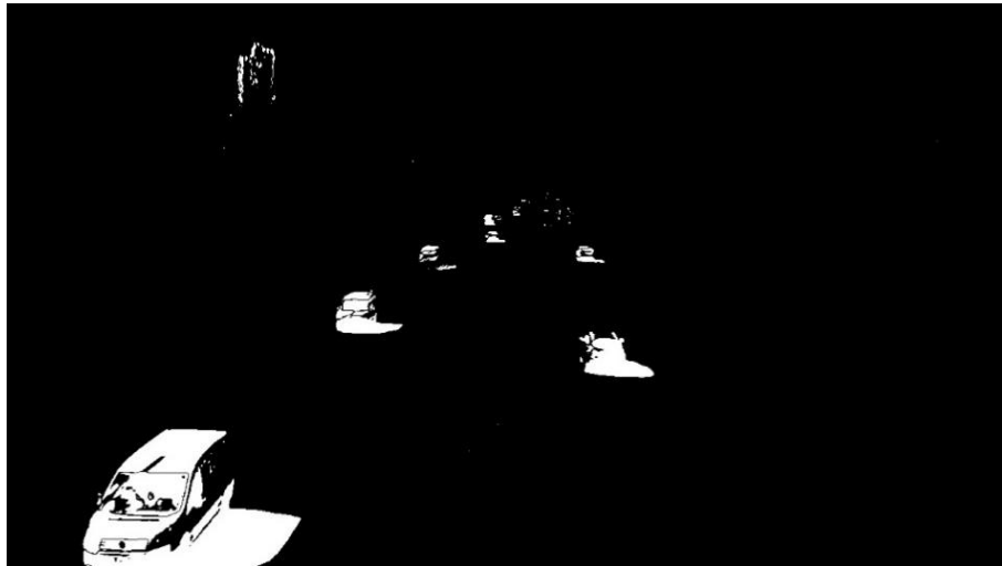
Figura 46 - Imagem binarizada após aplicação de subtração de fundo (MOG)
