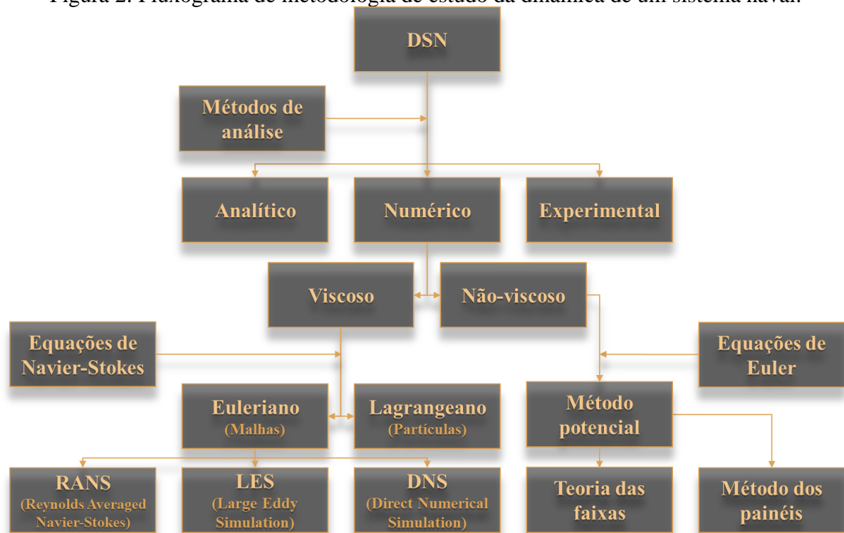
Figura 2: Fluxograma de metodologia de estudo da dinâmica de um sistema naval.
