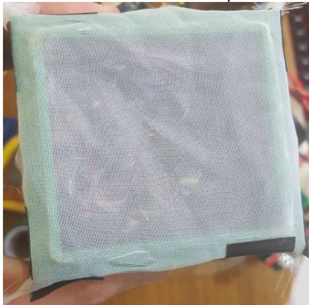
Figura 37: Foto do tecido microtule fixado no depósito como filtro de poeira.
