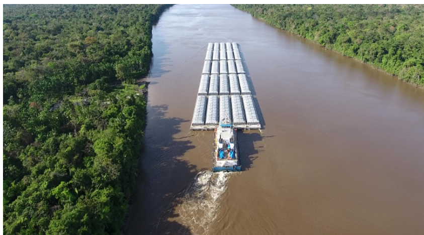
Figura 1 – Transporte de Comboio 5X5 de balsas e empurrador
