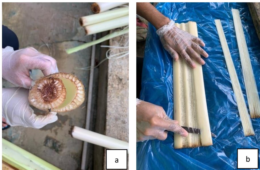
Figura 1. Obtenção das fibras da bananeira: a – separação das bainhas foliares presentes no pseudocaule da bananeira; b - retirada da camada externa, “capa”.
