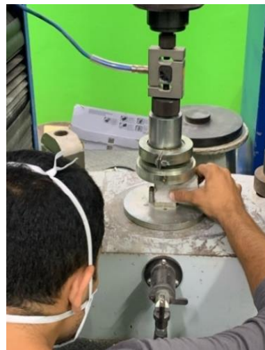
Figura 10. Ensaio de resistência à compressão. Fonte: Sousa, 2022.
