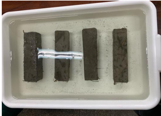
Figura 7. Ensaio de absorção de água Fonte: Sousa, 2022.
