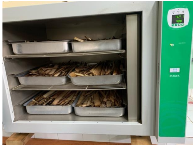
Figura 2. Secagem das fibras em estufa. Fonte: Sousa, 2022.
