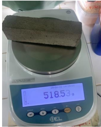
Figura 6. Ensaio de densidade aparente Fonte: Sousa, 2022.
