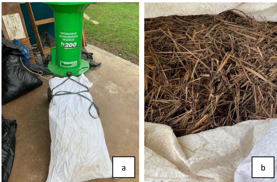
Figura 3. Homogeneização das partículas: a – trituração em triturador de galhos e resíduos orgânicos; b – fibras após o processo de trituração e peneiramento. Fonte: Sousa, 2022.
