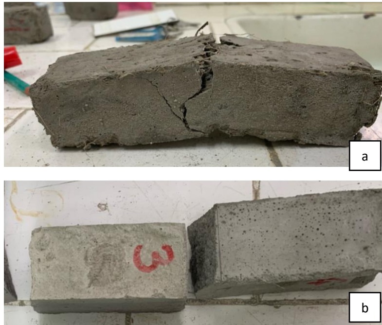
Figura 13. a – compósito com 2% de adição de fibras, com característica dúctil; b – compósito sem adição de fibras com ruptura brusca.
