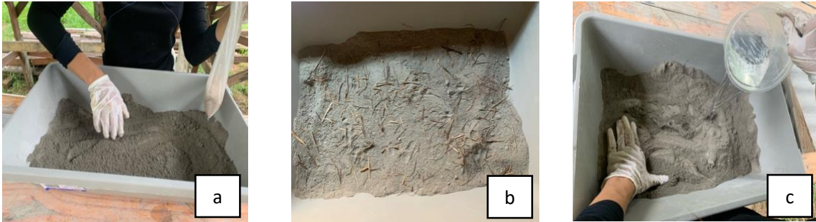
Figura 4. Preparação do compósito: a – mistura do cimento com a areia; b – adição gradativa das fibras; c – adição de água à mistura. Fonte: Sousa, 2022.
