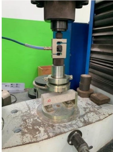
Figura 9. Ensaio de resistência à tração na flexão. Fonte: Sousa, 2022.
