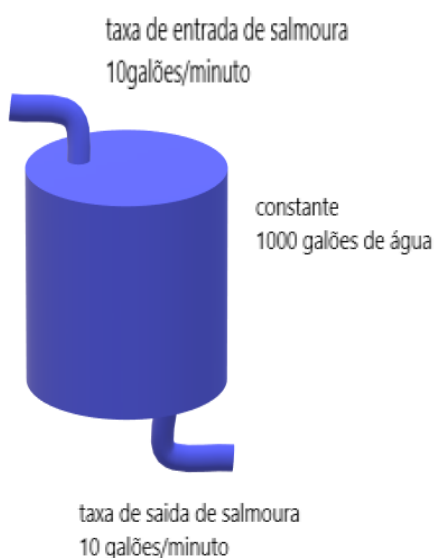
Figura 28 – Tanque de mistura
