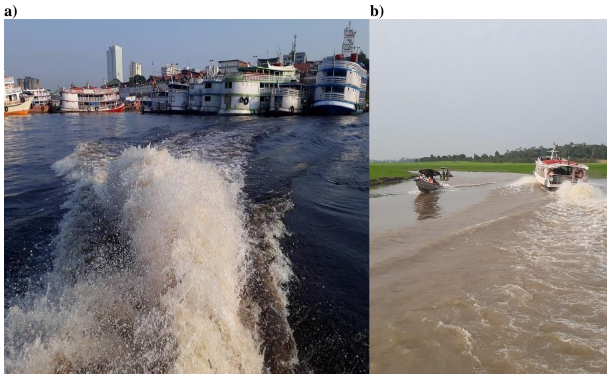
Figura 2 – Exemplos das ondas geradas por embarcações que podem afetar outras embarcações. a) Ondas atingindo embarcações ancoradas. b) Ondas prestes a atingir uma lancha pequena.
