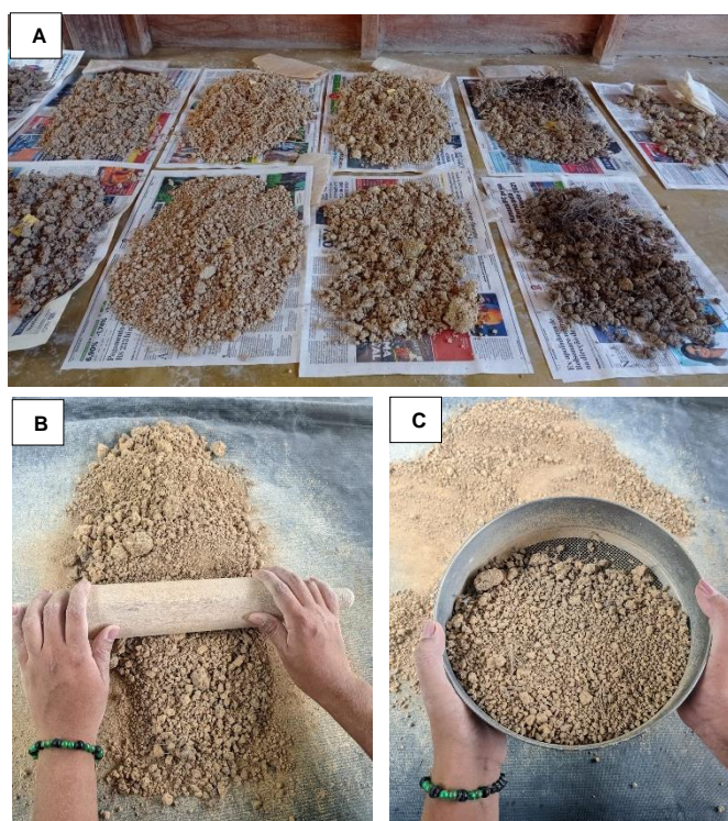
Figura 7 - Etapas para obtenção das amostras de TFSA. (A) Secagem ao ar; (B) Processo de destorroamento; (C) Peneiramento das amostras.
