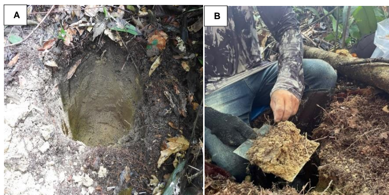
Figura 5 – Etapa para coleta: (A) Abertura mini trincheira; (B) Coleta de solo em forma de torrão. Fonte: Oliveira (2023)
