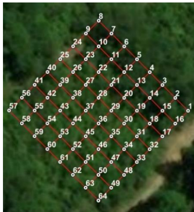
Figura 2 - Esquema de amostragem da malha de 70x70.
