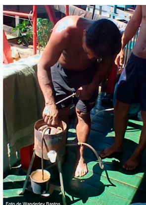
Figura 2. Foto ilustrativa de retorta sendo usada (esquerda) e esquema de funcionamento (direita) para captura do vapor de mercúrio, esfriamento e posterior recuperação do mercúrio líquido
