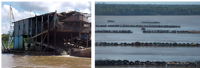
Figura 1. Fotos ilustrativas das balsas e dragas usadas na mineração de ouro na Amazônia
