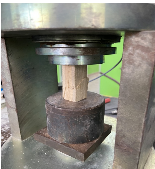
Figura 6 – Ensaio de resistência à compressão paralela. Fonte: Autor, 2023.
