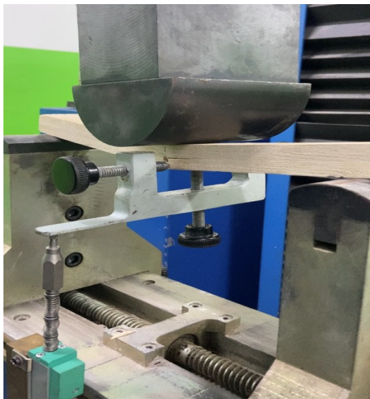
Figura 7 – Ensaio de resistência à flexão estática. Fonte: Autor, 2023.
