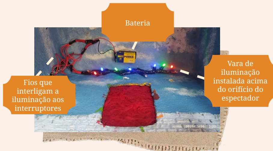
Figura 71 - Vista interna da iluminação
