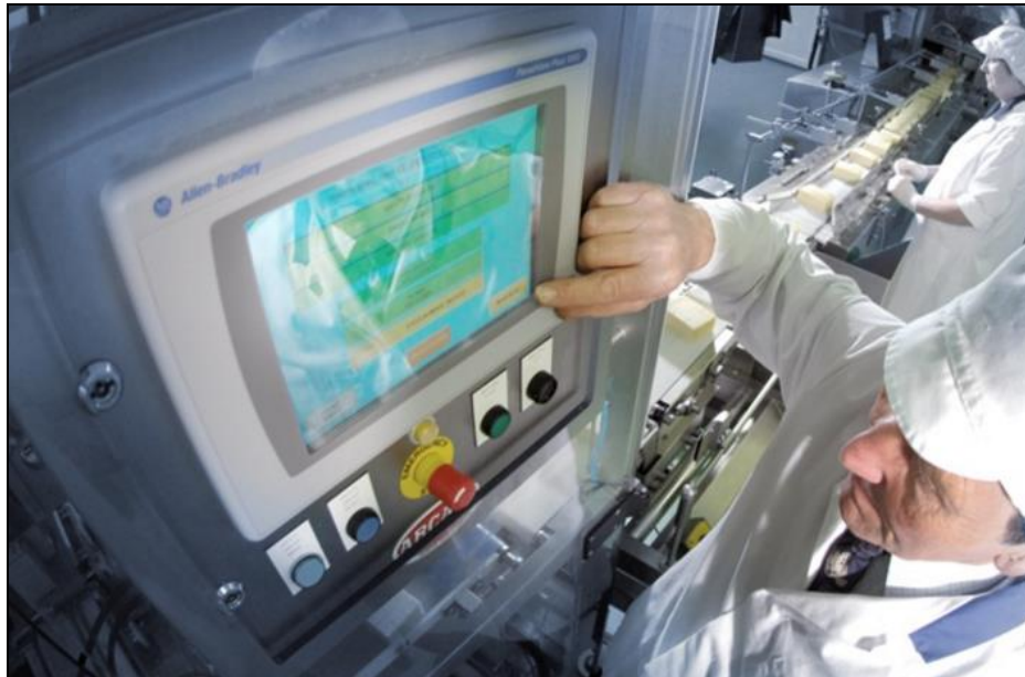
Figura 08 – Operador fazendo uso da IHM para intervir no processo.
