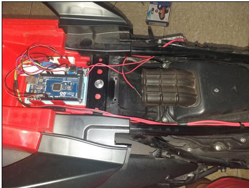
Figura 40 - Disposição dos fios do sistema na motocicleta
