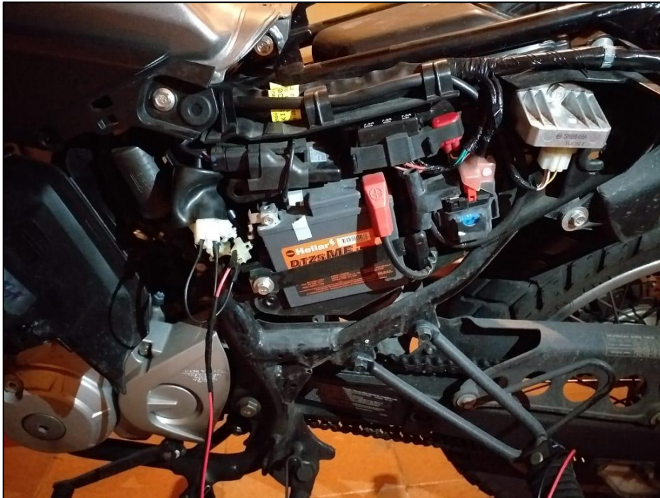
Figura 37 - Conexão do relé ao sistema de ignição
