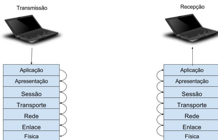
Figura 6 – Camadas do Modelo OSI
