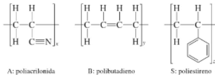
Figura 2- Unidades estruturais do ABS.
