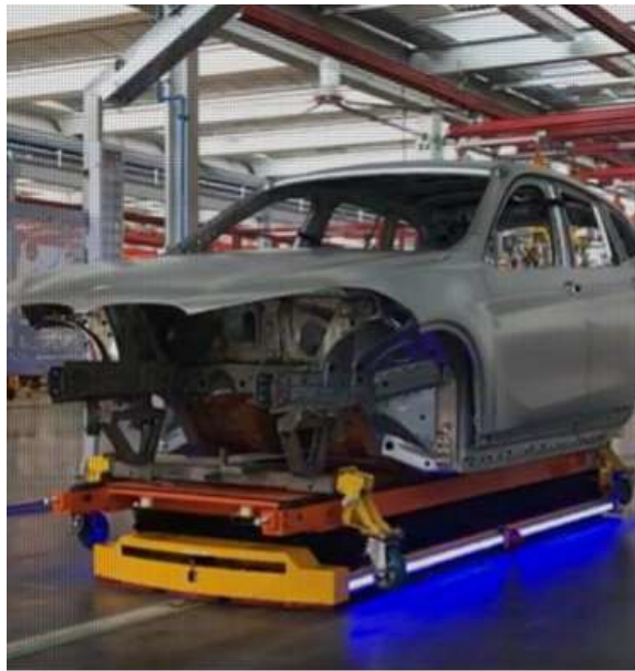
Figura 12-AGV plataforma na indústria
