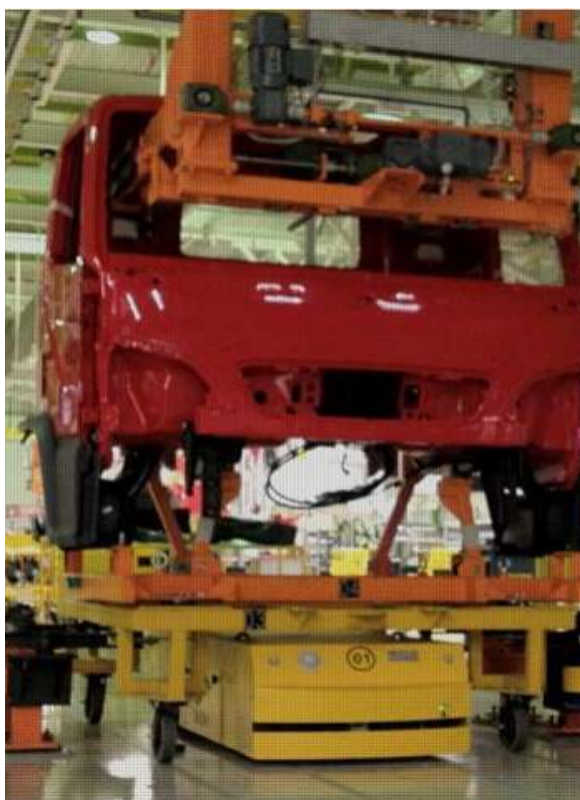
Figura 6-AGV de arraste na indústria
