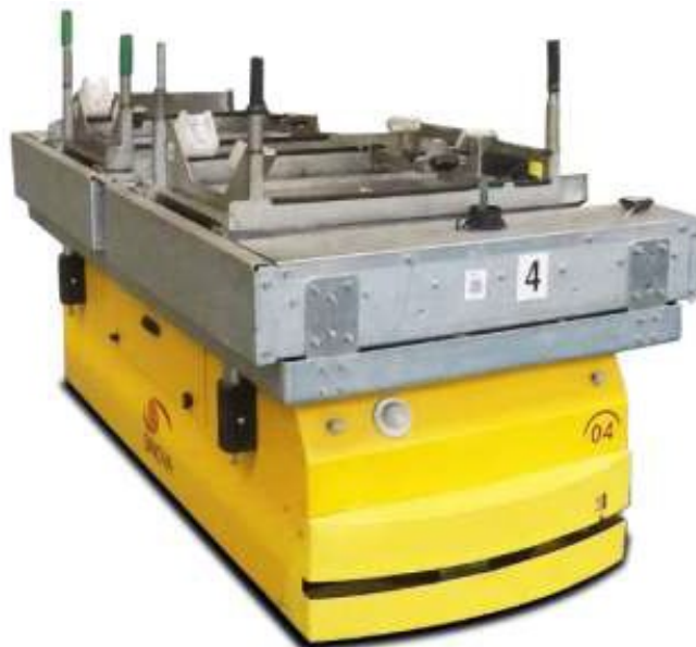
Figura 9-Representação AGV com mesa de transferência
