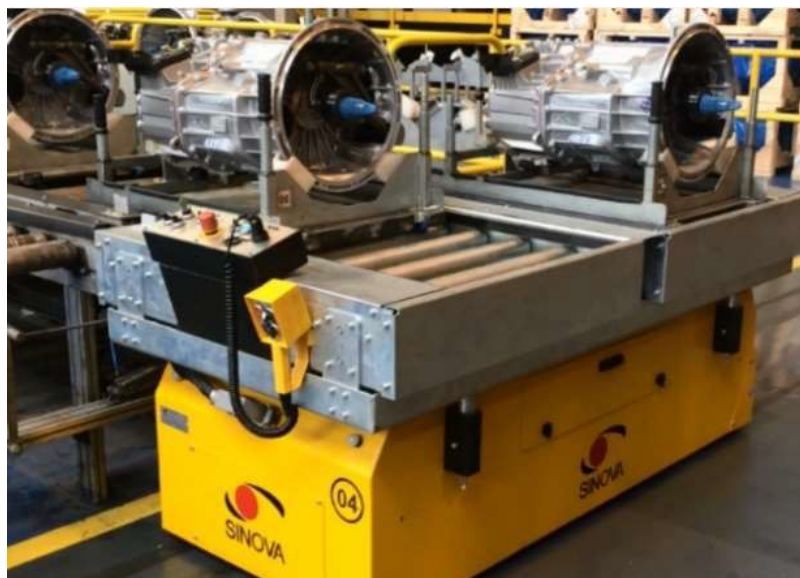
Figura 8-AGV com mesa de transferência na indústria
