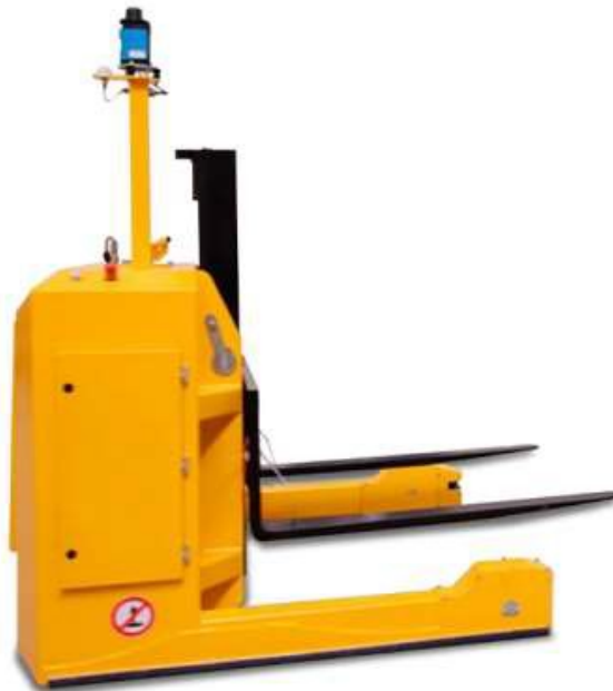
Figura 11-Representação AGV empilhadeira
