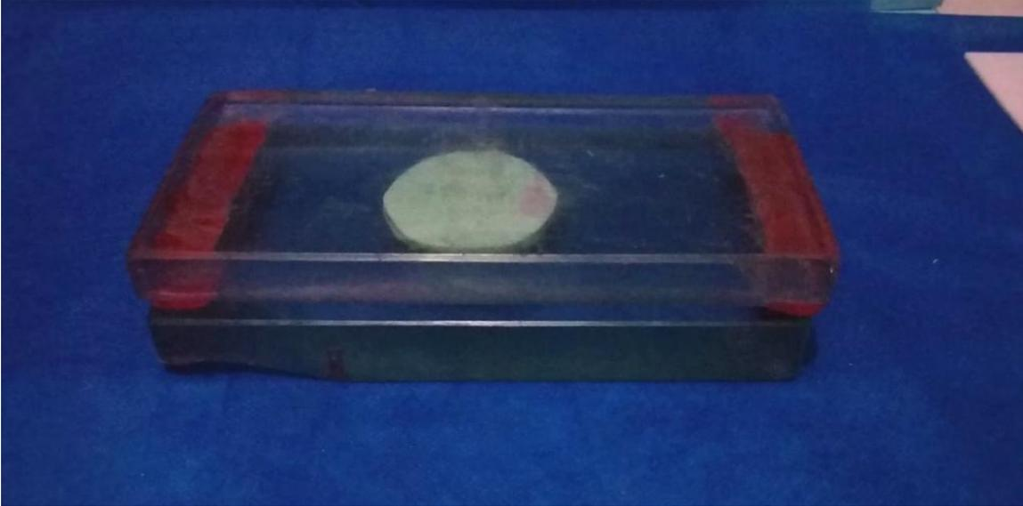
Figura 3. Matriz de silicone de condensação, obtida pela compressão de duas placas de vidro.
