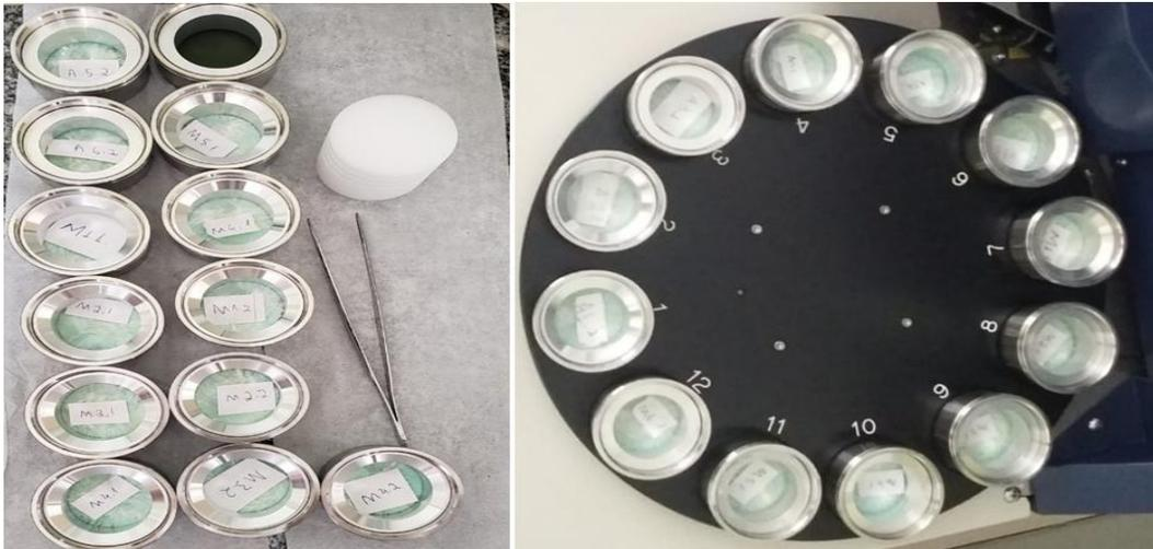
Figura 8. Acomodação das matrizes de silicone de condensação contendo as amostras no porta amostras do equipamento espectrômetro.
