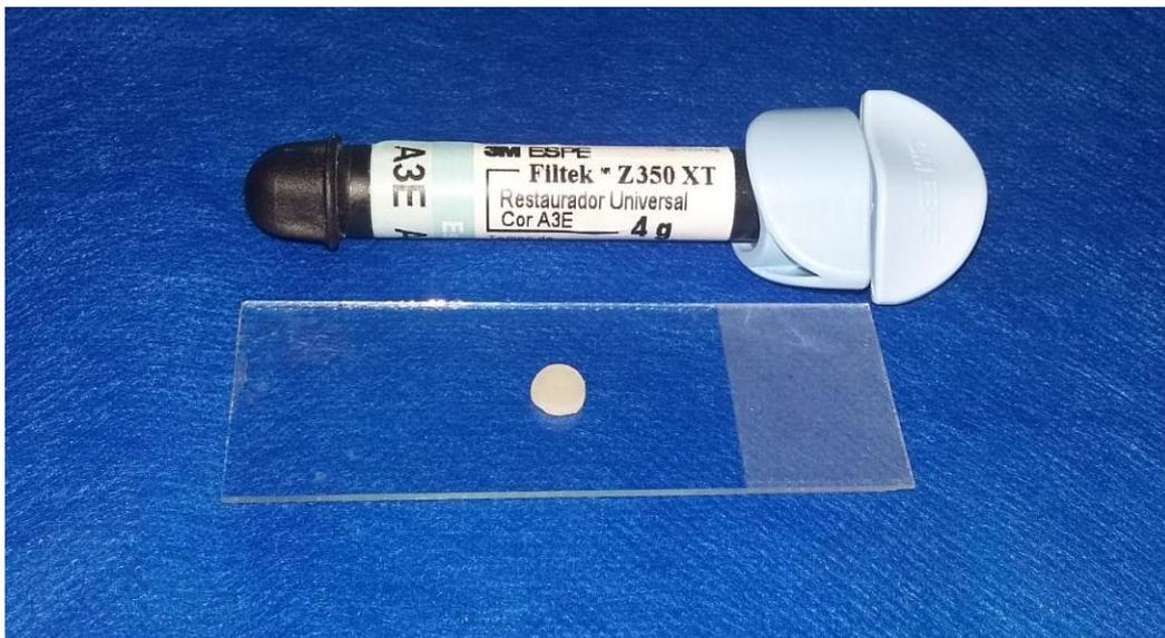
Figura 2. Corpo de prova da resina composta nanoparticulada Filtek Z350 A3E, marca 3M ESPE.
