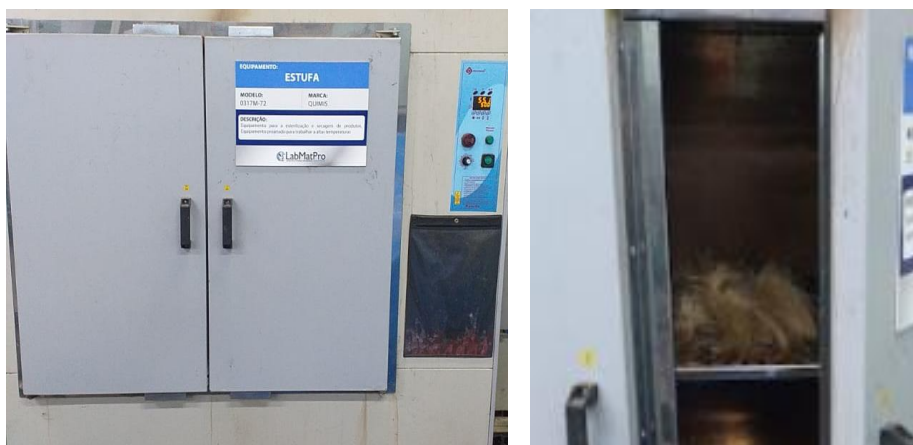
Figura 16 - 1) Estufa QUIMIS; 2) Fibras em desumidificação na estufa
