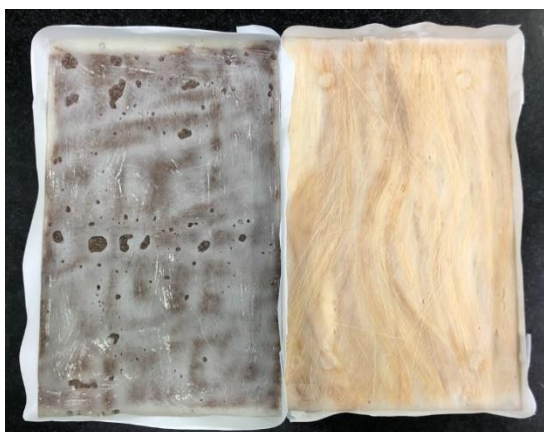
Figura 27- 1) Bordas de papel de 10mm na matriz de juta; 2) Bordas de papel de 10mm na matriz de sisal
