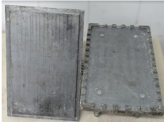
Figura 21- Molde utilizado para confeccionar as matrizes
