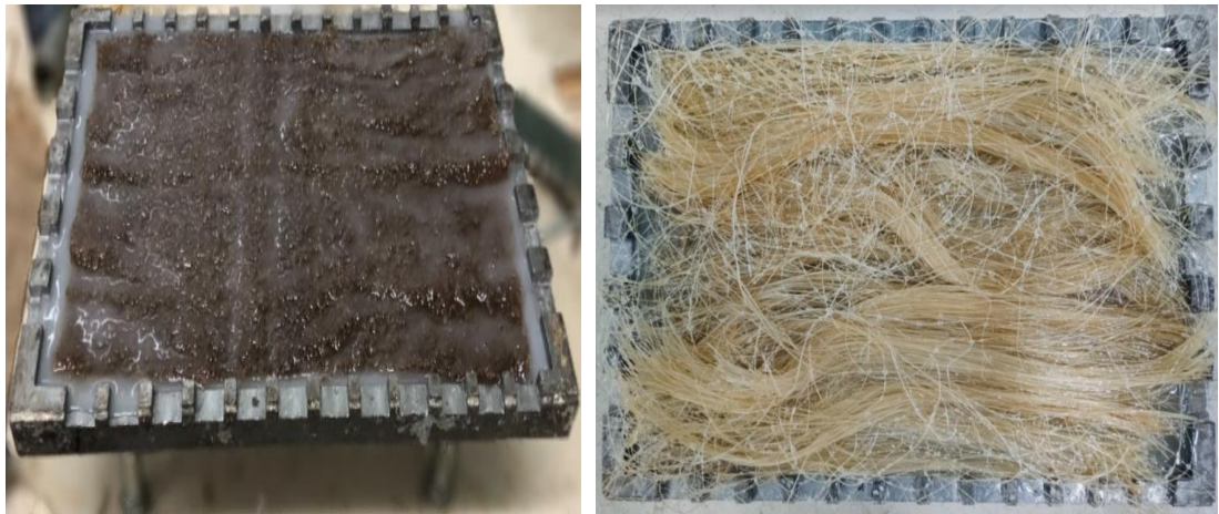
Figura 19 - 1) Molde preenchido com resina e fibra de juta; 2) Molde preenchido com resina e fibra de sisal
