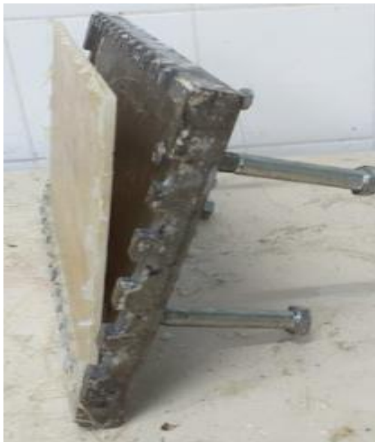
Figura 22 - Matriz de sisal sendo desmoldada
