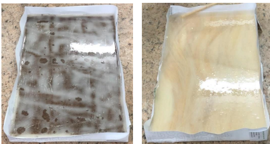
Figura 28 - 1) Matriz de juta preenchida com resina; 2) Matriz de sisal preenchida com resina
