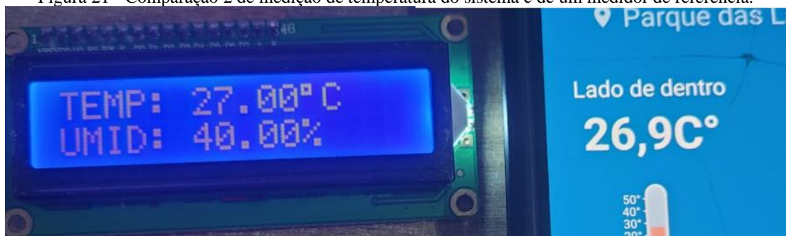
Figura 21 - Comparação 2 de medição de temperatura do sistema e de um medidor de referência.
