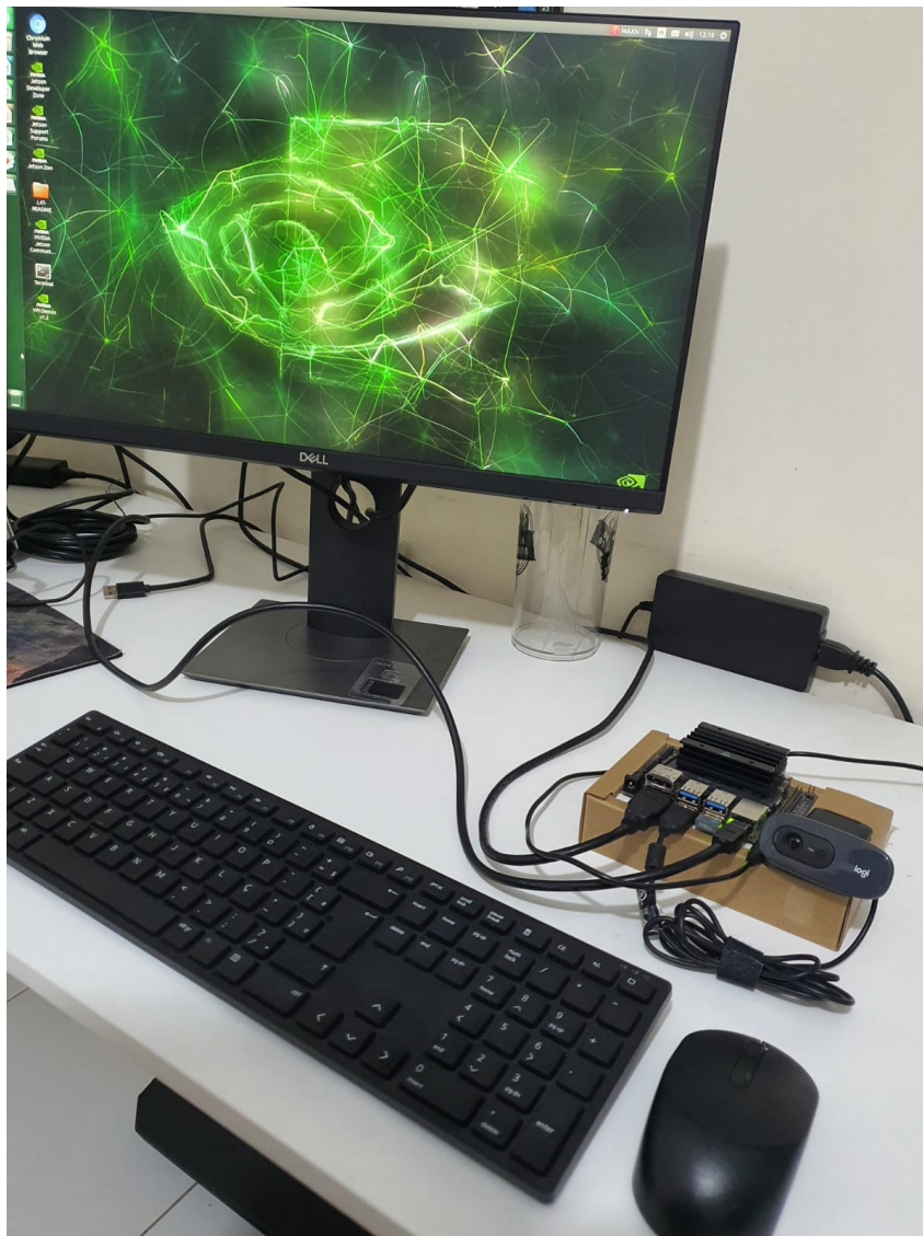
Figura 20 – Periféricos conectados na plataforma Jetson Nano e, ao lado esquerdo, exibição do sistema operacional através de um monitor conectado via cabo HDMI.
