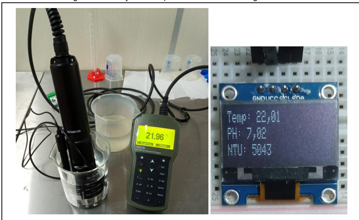
Figura 36 - Medição da temperatura da amostra de água mineral.
