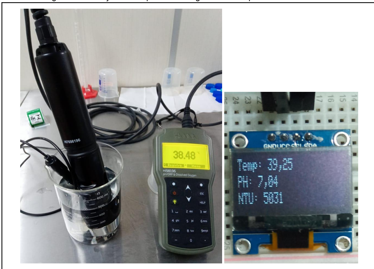
Figura 35 - Medição da temperatura da água mineral aquecida no microondas.
