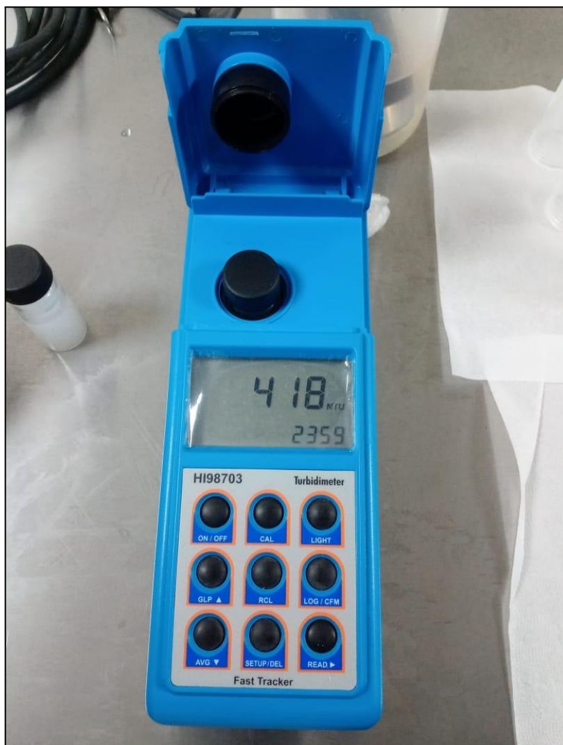
Figura 32 - Aferição da turbidez da água por meio do software.
