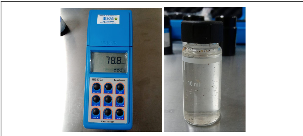
Figura 30 - Aferição da turbidez da segunda amostra com o equipamento HI98703.
