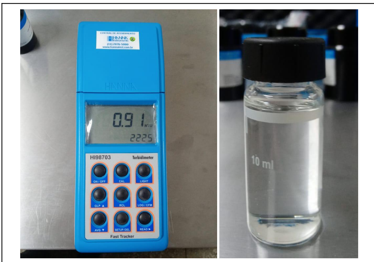
Figura 28 - Aferição da turbidez da água mineral com o equipamento HI98703.
