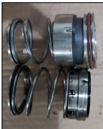
Figura: Substituição do Selo mecânico
