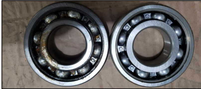
Figura: Substituição de Rolamentos
