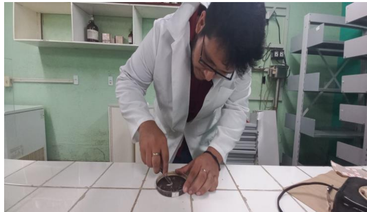
Figura 7 -Processo de raspagem das placas após a evaporação do líquido.
