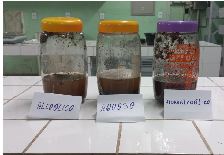
Figura 4 - Folha secas trituradas emergidas no solvente alcoólico, hidroalcoólico e aquoso.
