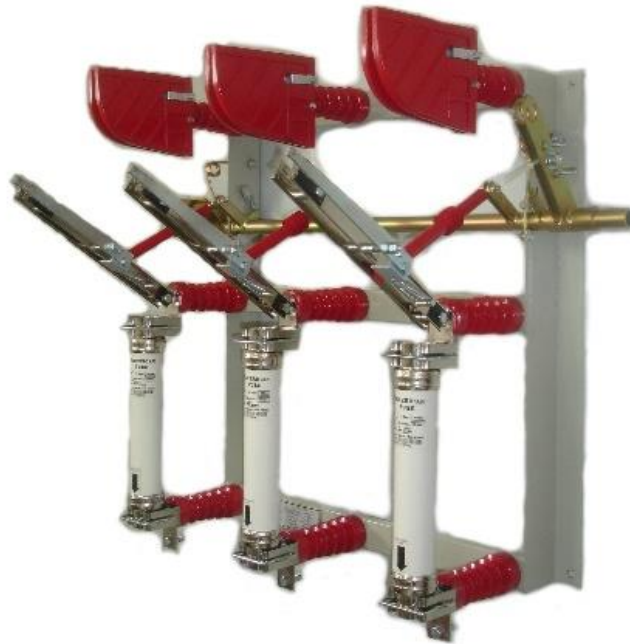
Figura 6 – Chave Seccionadora tripolar 15 kV de 200 A com acoplamento para fusíveis.
