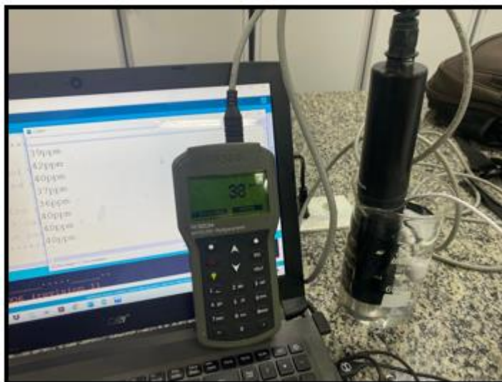
Figura 32 - Validação das Medições do Sensor TDS.
