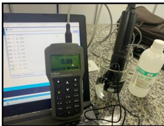
Figura 29 - Validação das medições do sensor de pH PH4502C.
