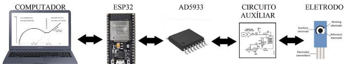
Figura 14 - Esquema de ligação do sistema microcontrolado para aquisição de impedância.
