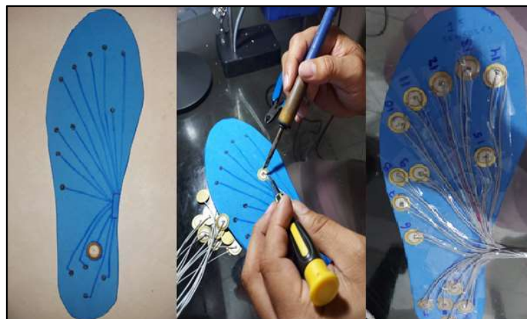
Figura 32 – Construção da palmilha N42 - 15 sensores
