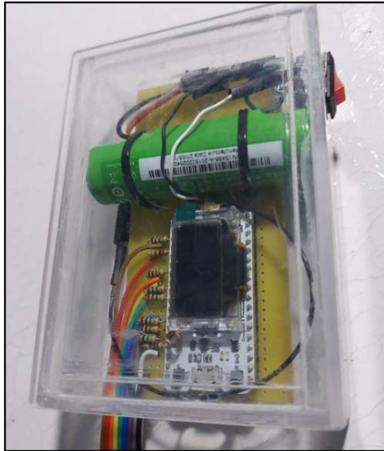
Figura 52 – Circuito montado com caixa de proteção
