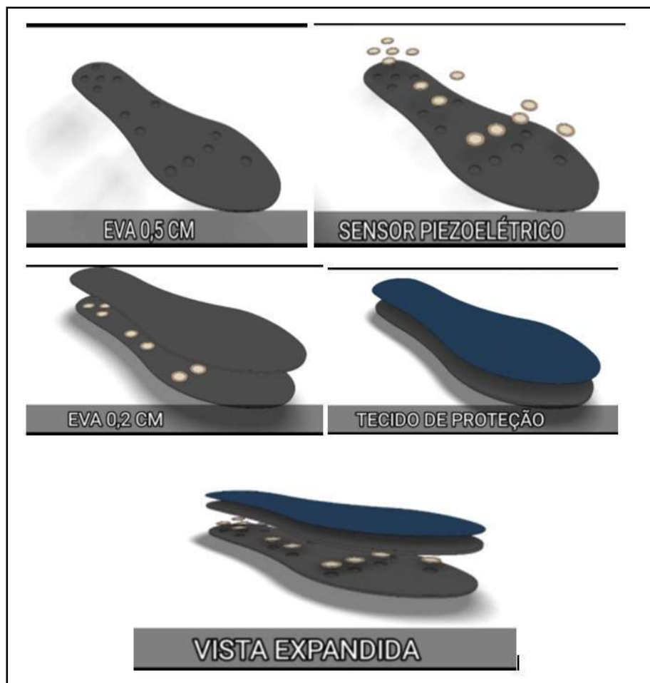
Figura 30 – Fases da montagem da palmilha N42 - 15 sensores
