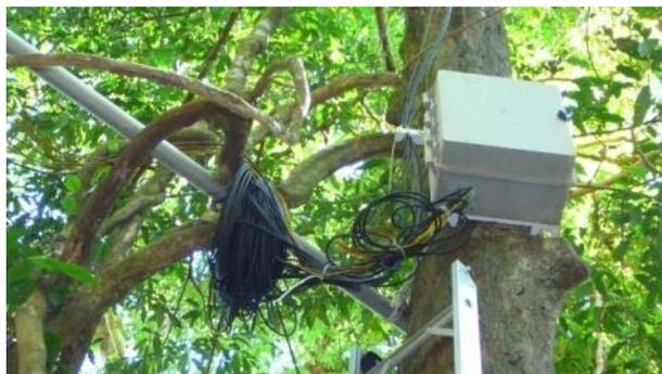
Figura 2.2 - Datalogger instalado na árvore a 5,0 m de altura.
