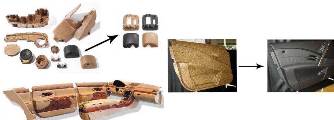
Figura 2.6 - Partes interiores de automóveis fabricadas com madeira plástica (Fonte: FARSI, 2012)
