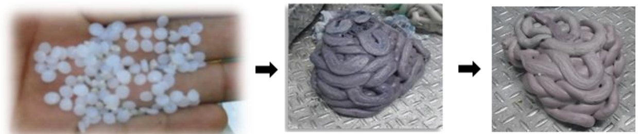
Figura 19: Proposta: Utilizar um produto específico para limpeza no setup. Fonte: Próprio autor, 2021.
