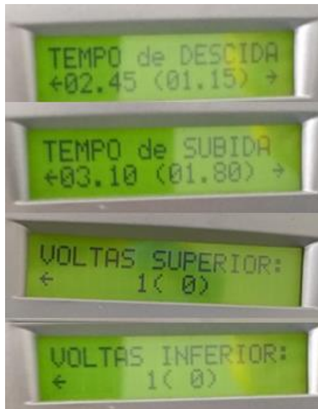
Figura 12 - Parâmetros da máquina envolvente Amostra 01.
