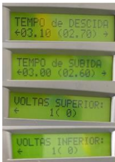
Figura 15 – Parâmetros da máquina envolvedora Amostra 02.
