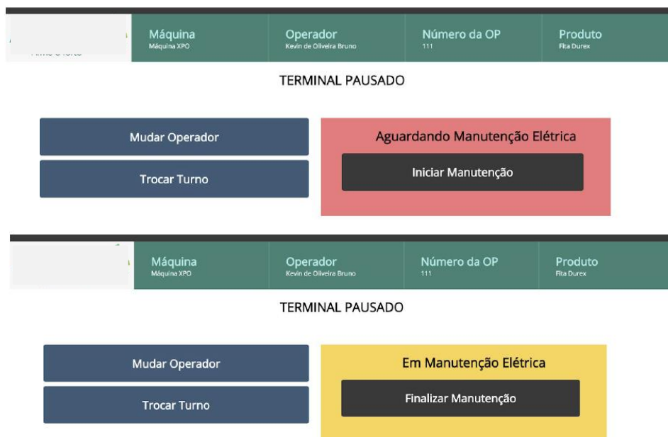
Figura 33 – Tela do terminal do Operador para início e finalização de manutenção
