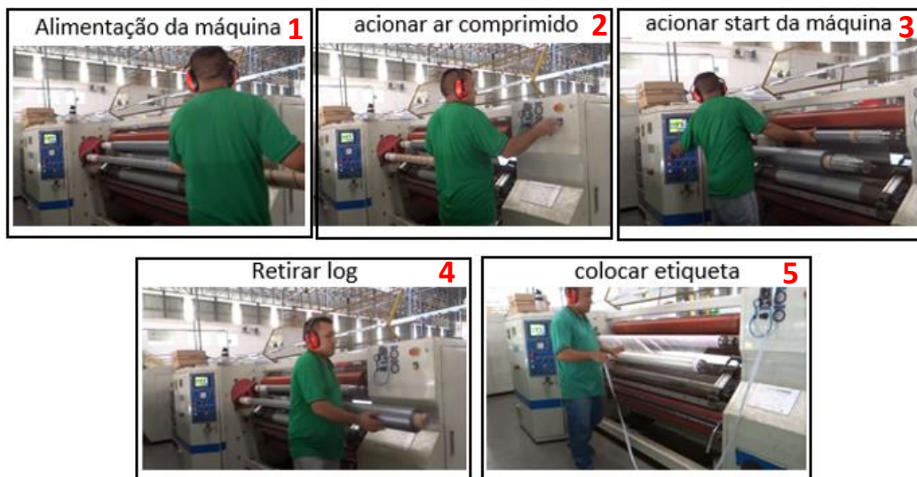
Figura 10 - Sequência de operação da máquina rebobinadeira 3”
