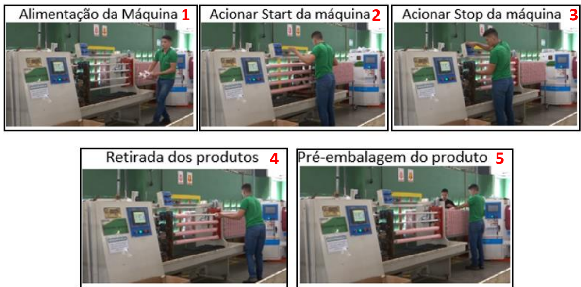
Figura 8– Sequência de operação da máquina fatiadeiras 4 eixos fixos 1”
