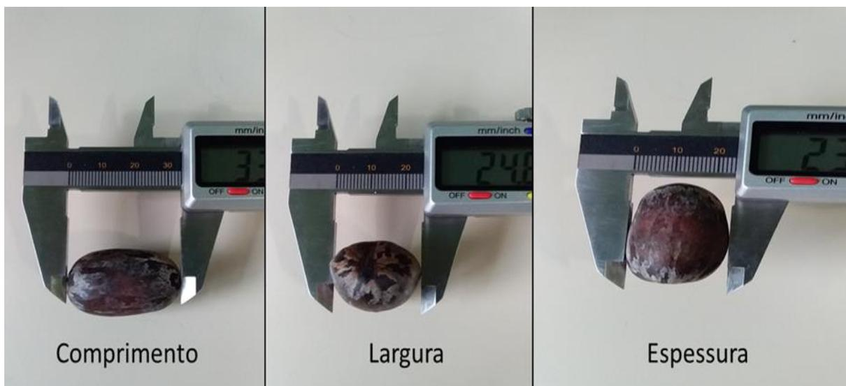
**Figura 5:** Medidas de comprimento, largura e espessura das sementes.
