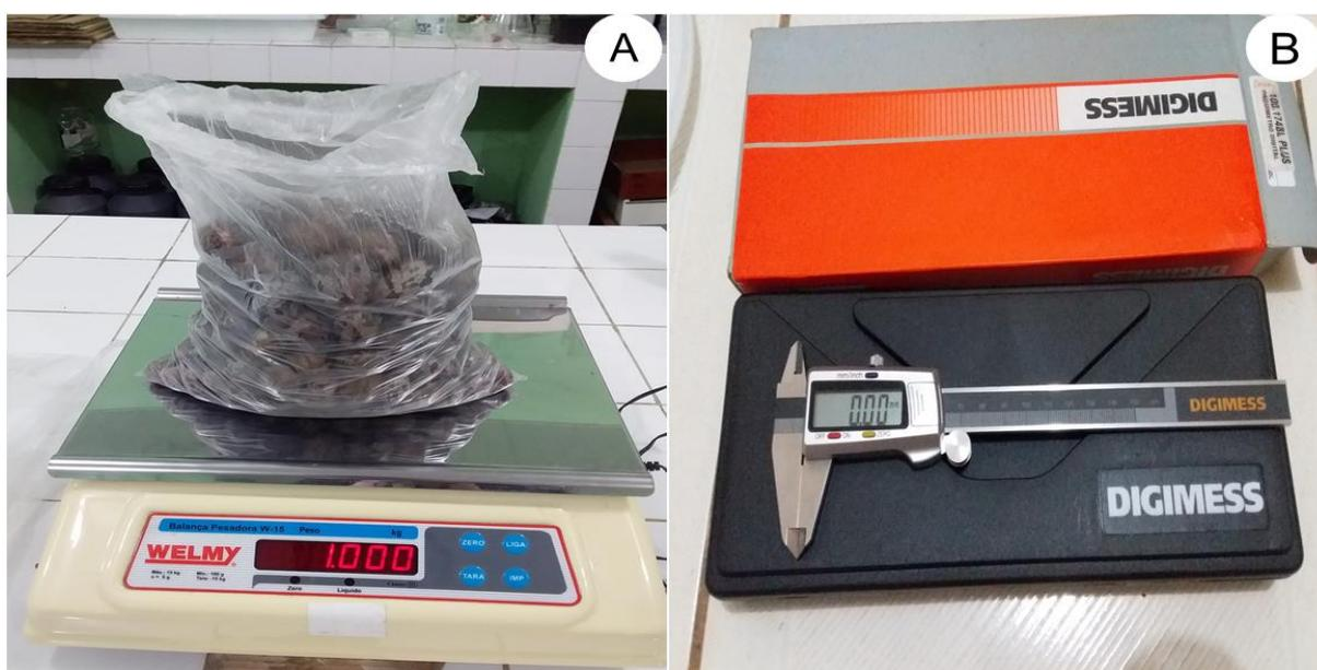
**Figura 4:** Equipamentos utilizados para pesar e medir as sementes de seringa: Balança Comercial (A) e Paquímetro Digital (B).
