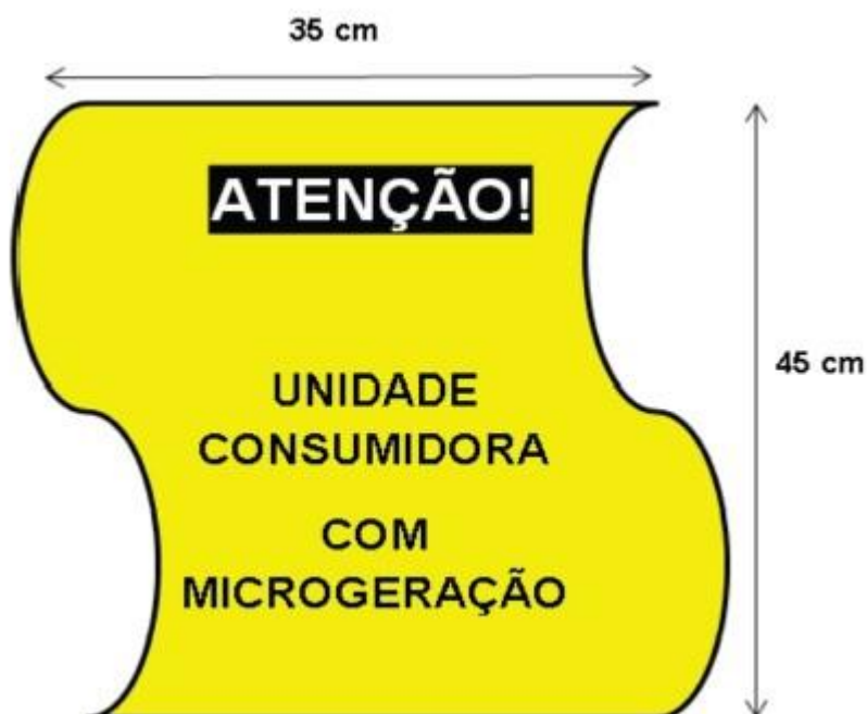
Modelo de bandeirola para o ramal de ligação da unidade com microgeração.
