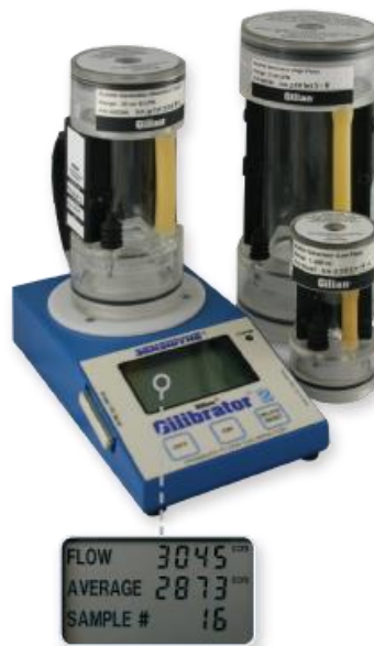
Figura 7 - Calibrador Gilian Gilibrator-2.
