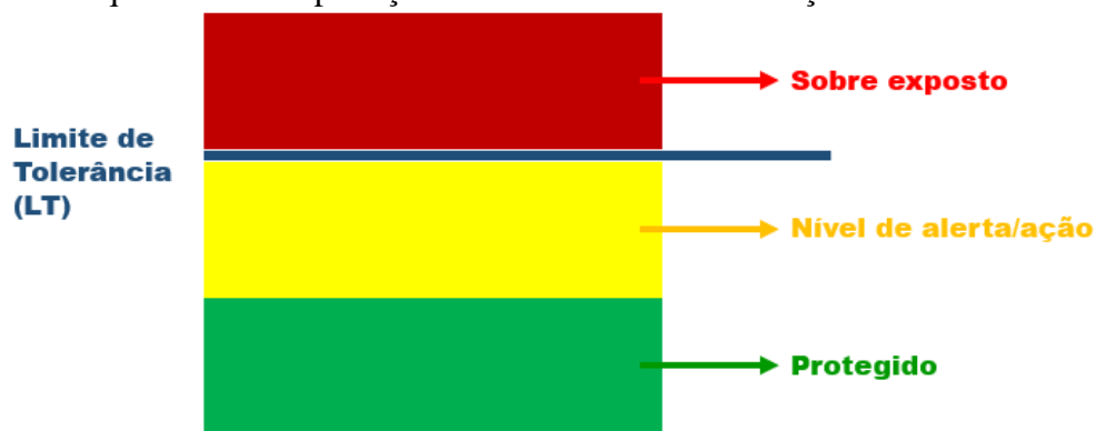
Figura 11 - Esquema de Interpretação dos Resultados com Relação ao Limite de Tolerância.
