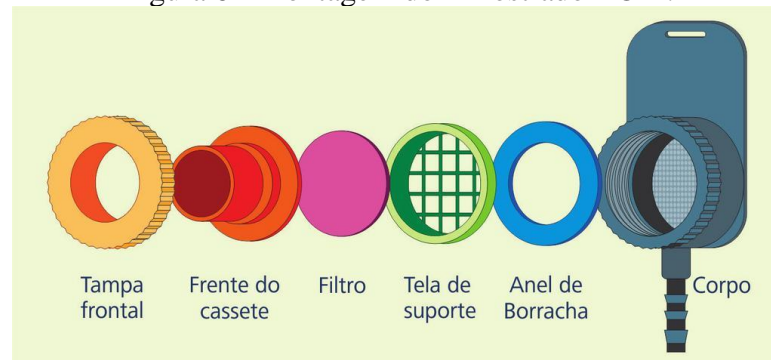
Figura 6 - Montagem do Amostrador IOM.
