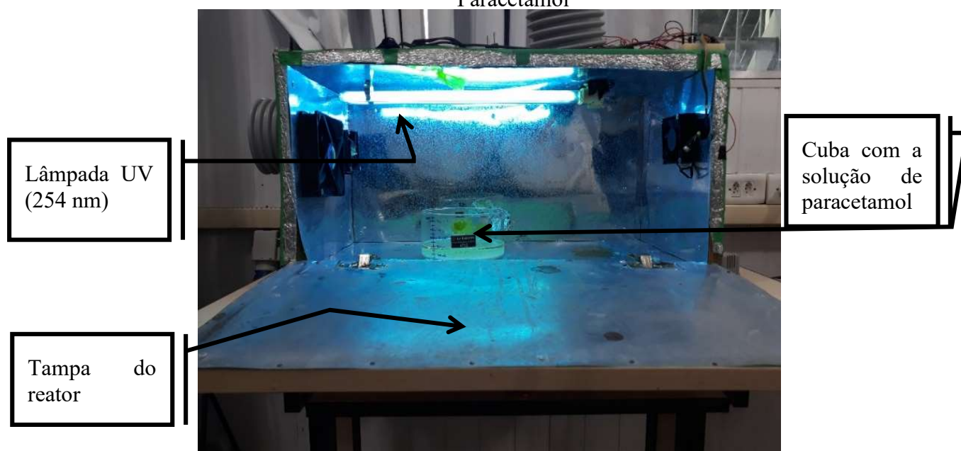
Figura 6 - Reator Fotocatalítico Empregado no Processo de Degradação do Paracetamol
