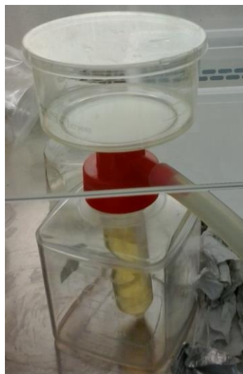
Figura 12. Sistema de filtração à vácuo utilizado para obter os extratos enzimáticos.
