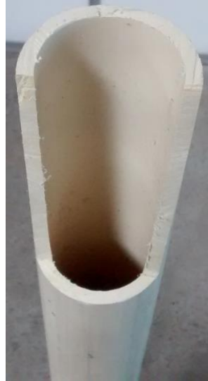
Figura 11: Corte no tubo PVC
