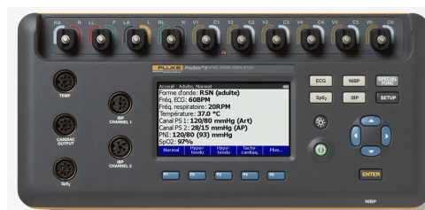
Figura 23 – Simulador de sinais vitais - PROSIM3-FLUKE
