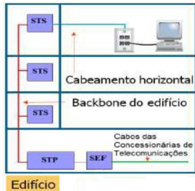
Figura 18 - Exemplo Topologia Física de uma rede de Telemática
